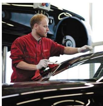
Kleine Schäden in der Frontscheibe lassen sich reparieren, sofern sie sich nicht Die Reparatur von Glasschäden sollte in die Hände eines Kfz-Meisterbetriebs im Sichtfeld des Fahrers befinden und eine bestimmte Größe nicht überschreigelegt werden, da bei modernen Pkws nach einem Scheibentausch auch Assistenzsysteme neu kalibriert werden müssen.
