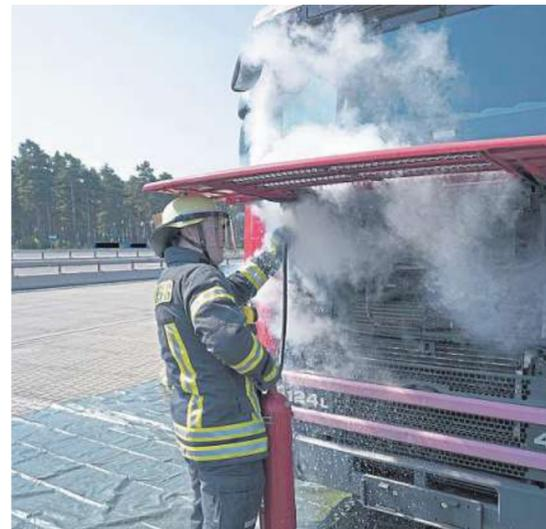
Mit einem Feuerlöscher wurde der Motor zum Stillstand gebracht, falls ein Zugang zum Zündschlüssel nicht gegeben ist.
