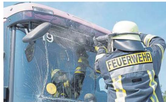
Mit einer Säbelsäge wurde die Frontscheibe aufgeschnitten, damit ein schneller Zugang zur verunfallten Person entstehen kann.
