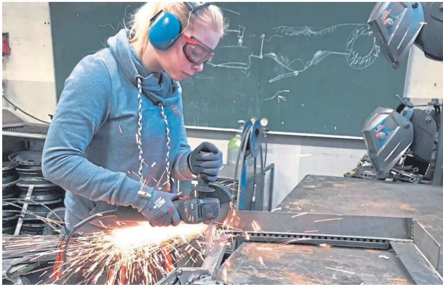
Julia schneidet mit dem Winkelschleifer ein Bauteil für einen Grillrost.
