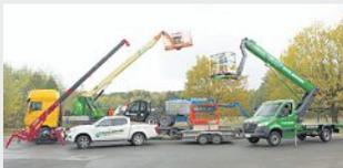
Diverse Geräte wie z.B. 10-Meter-Mastliftbühne, 6-Meter-Teleskopstapler, 28-Meter-Teleskopbühne sowie 3,5-Tonnen-Minikran.
