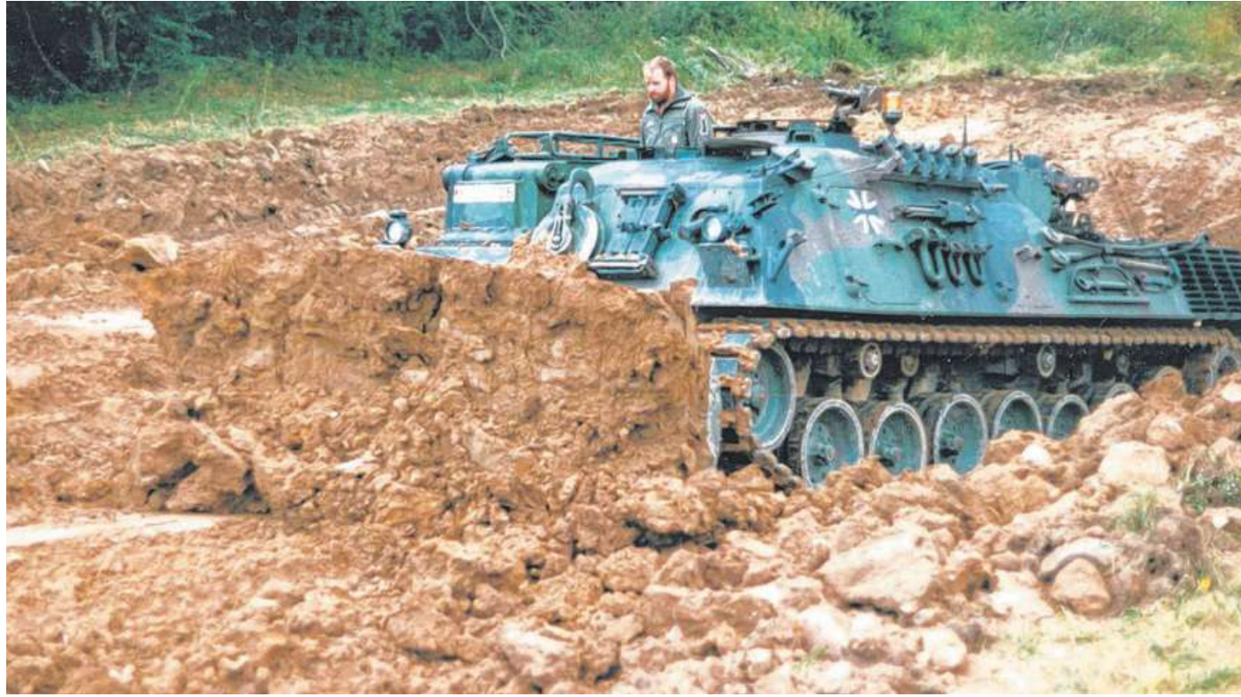
Der Pionierpanzer „Dachs“ bringt den Panzertreck auf dem Nienburger Standortübungsplatz in Form.
