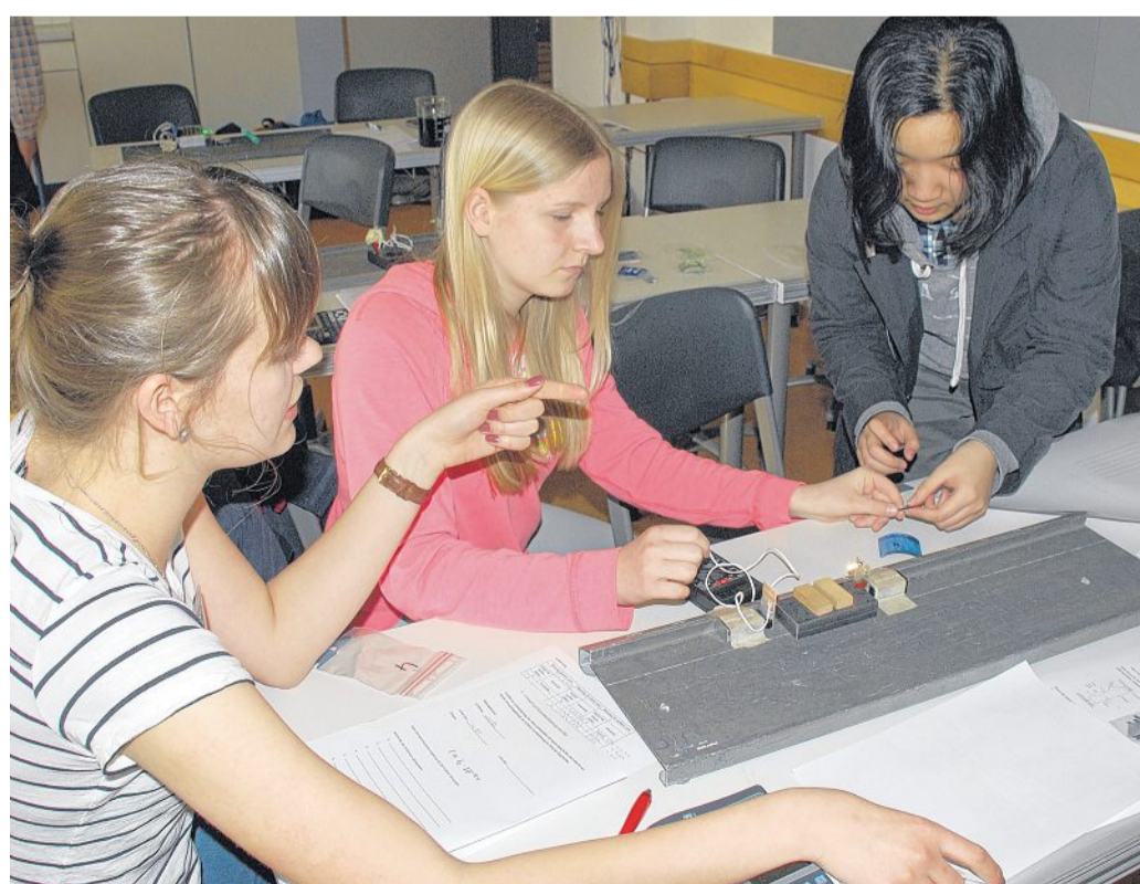
Sarah Niefeld, Insa Seonbuchner und Yina Du bei der Dickenbestimmung von Glasscheiben mithilfe der Absorption von Lichtstrahlung. Zuvor muss der Absorptionskoeffizient der Lichtstrahlung in einer Eichmessung ermittelt werden. Dabei müssen Exponentialfunktionen aus der Mathematik angewendet werden.
