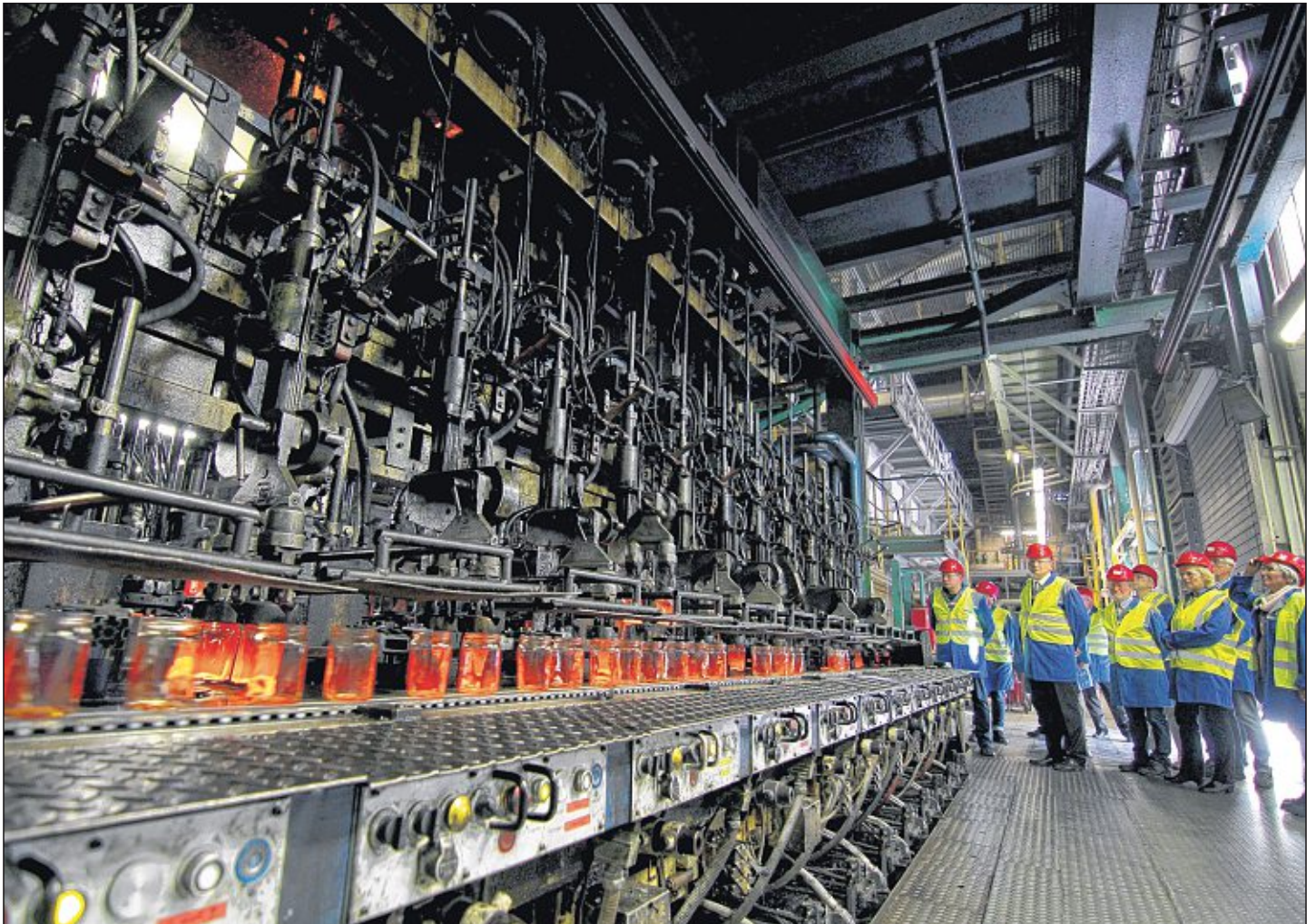
Die Gruppe der Klimaschutzagentur sieht an einer Fertigungsmaschine, wie weiße Glasbehälter hergestellt werden.
