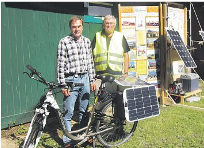
Die mobile Solarstation von Joachim Kreuzer (links im Bild) passt auf jedes E-Bike. Packtaschen lassen sich unter der Anlage problemlos anbringen. Horst Beyer vom ADFC überzeugt sich von der Konstruktion. DH
