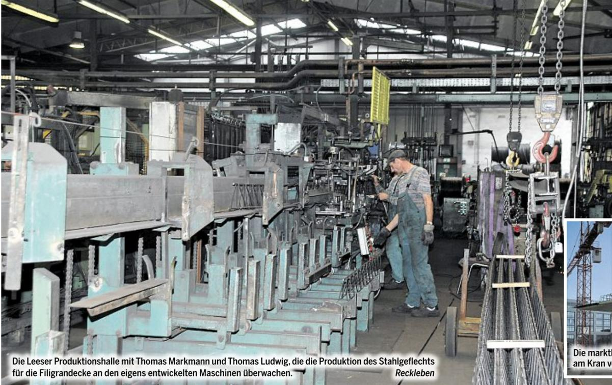
Die Leeser Produktionshalle mit Thomas Markmann und Thomas Ludwig, die die Produktion des Stahlgeflechts für die Filigrandecke an den eigens entwickelten Maschinen überwachen.
