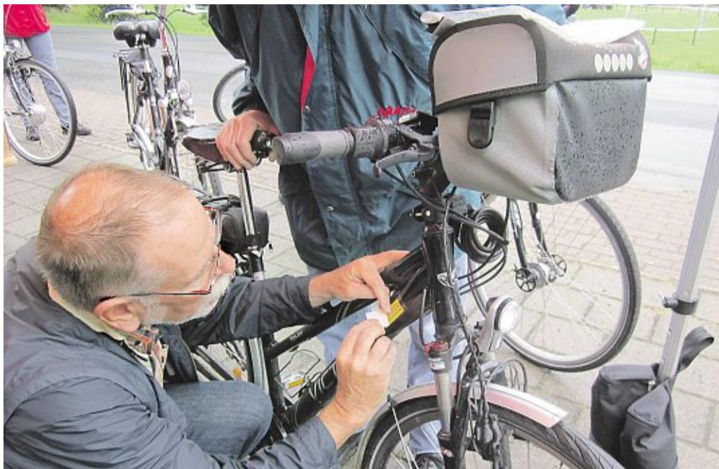
Die Spezialcodieraufkleber des ADFC härten nach dem Aufbringen aus. Die Eigentümer-Identifizierungs-Nummer (EIN) ist gut sichtbar. Hans Guillaume bringt hier den Erstaufkleber mit der Kennzeichnung auf.
